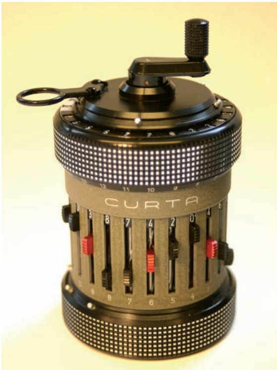
Die kleinste je gebaute mechanische Rechenmaschine, die ab 1954 hergestellt wurde: die „Curta“ (Type II – System Curt Herzstark)
