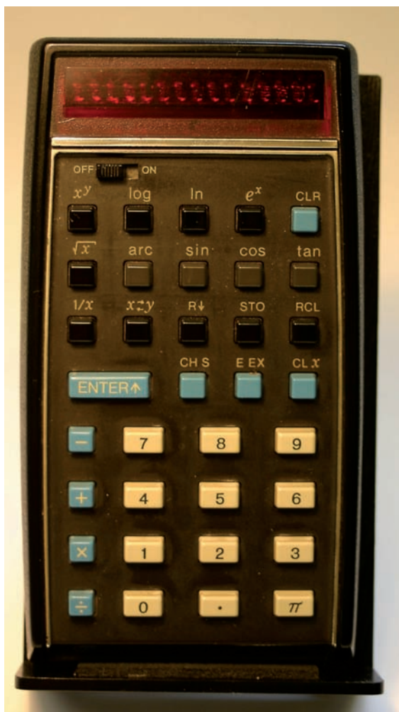
Der erste technisch-wissenschaftliche Taschenrechner von Hewlett-Packard: das Modell HP 35 (ab 1972 hergestellt)
